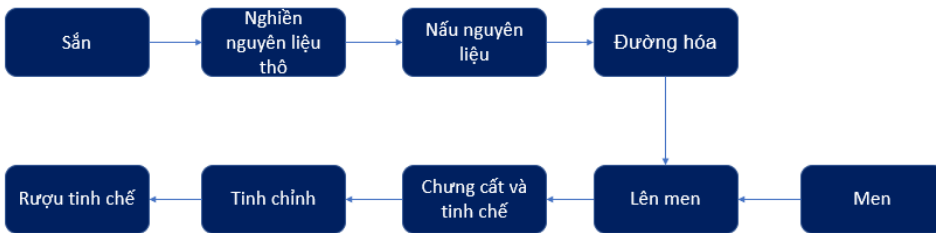
Hình 15: Quy trình sản xuất Ethanol
